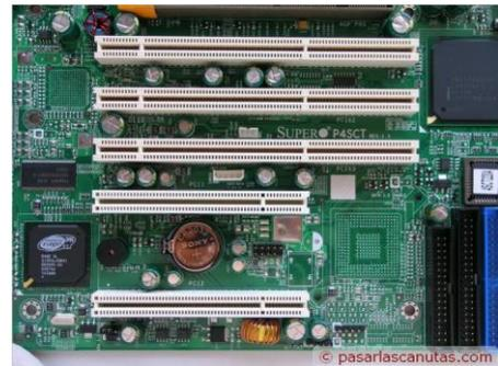
Los **buses de datos** son las pistas o canales que conectan entre si todos los componentes de la placa base. La información circula a través de ellos en forma de señales eléctricas en el sistema binario.
