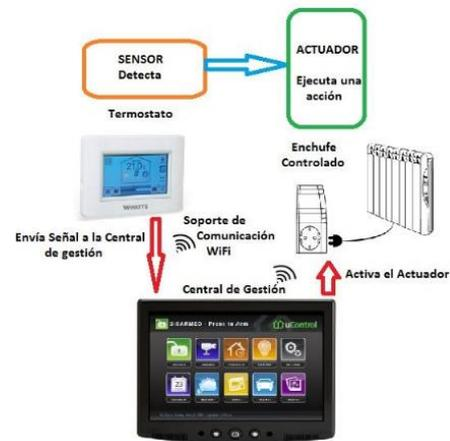
Figura 5 - Esquema elementos de instalación domótica
