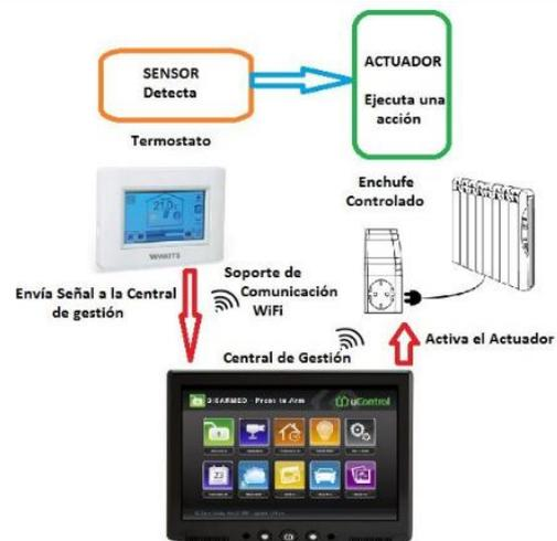
Figura 5 - Esquema elementos de instalación domótica
