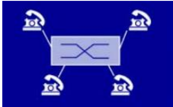
Figura 2 - Interconexión de teléfonos mediante conmutador
